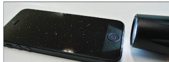
図1 暗視野照明法 实例の写真は、クオタム スーパーライトによるもので、特有の強力な直進光でゴミ・異物を浮かび上がらせている。
